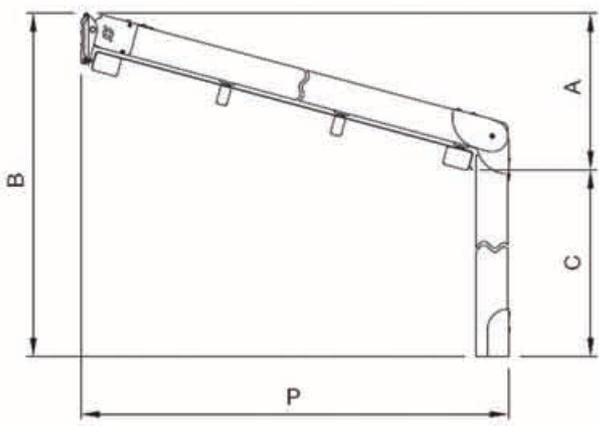
Pente minimum pour évacuation des eaux pluviales.
