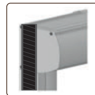
ENTRE PAREDES (Fijación Guías)
